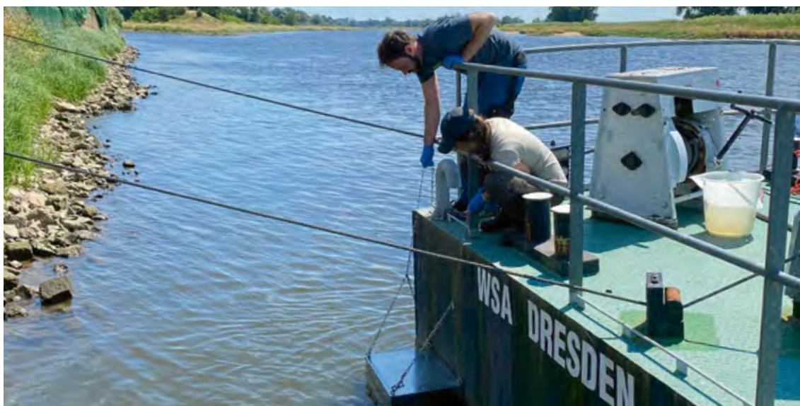
Abbildung 76: Platzierung einer Schwebstofffalle an der Elbe (Lutherstadt Wittenberg) im Mai 2022.
